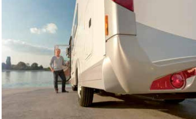
Il sollevamento massimo dell'assale anteriore e l'abbassamento massimo dell'assale posteriore consentono un comodo caricamento del vano posteriore o del portatutto posteriore.
