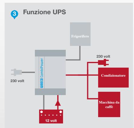
Senza presa di rete esterna. Grazie a CombiPower, la corrente per le utenze collegate viene generata dalla batteria. L'inverter integrato la trasforma in pura corrente alternata a 230 volt.
