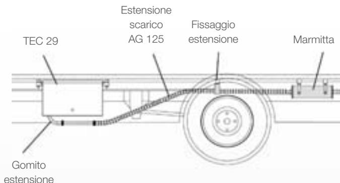
Utilizzare il tubo flessibile in metallo (2 metri in dotazione con la marmitta) per il montaggio del tubo di scarico. Un'ulteriore estensione dello scarico (AG 125) è disponibile come opzione. Tutti i componenti mostrati sono nella dotazione di TEC 29 / TEC 29LPG.
