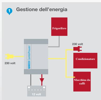
Collegamento a una presa di rete esterna che alimenta tutte le utenze a 230 volt. Contemporaneamente viene caricata la batteria delle utenze.
