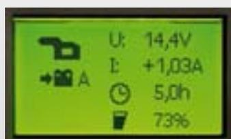
Dati attuali della batteria: tensione, corrente, durata residua, capacità
