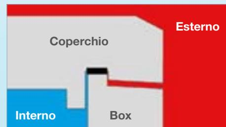
La guarnizione a labirinto impedisce al calore di penetrare all'interno.
