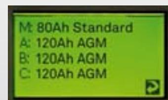
Visualizzazione della configurazione di tutte le batterie collegate
