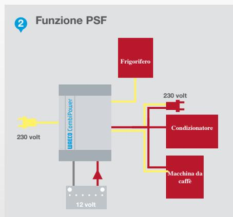
Collegamento a una presa di rete esterna con capacità insufficiente per alimentare le tre utenze attive. L'inverter integrato assicura il funzionamento delle utenze.
